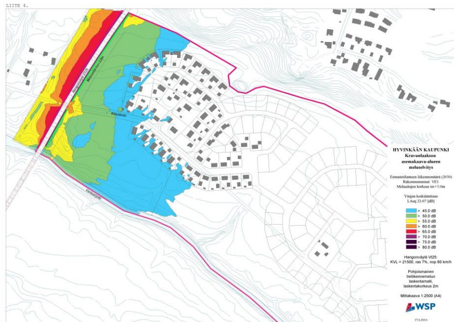
Kuva 17. Vaihtoehto 1 meluaidalla ennustetilanteessa v. 2030 (LAeq 22-07), WSP 2014
