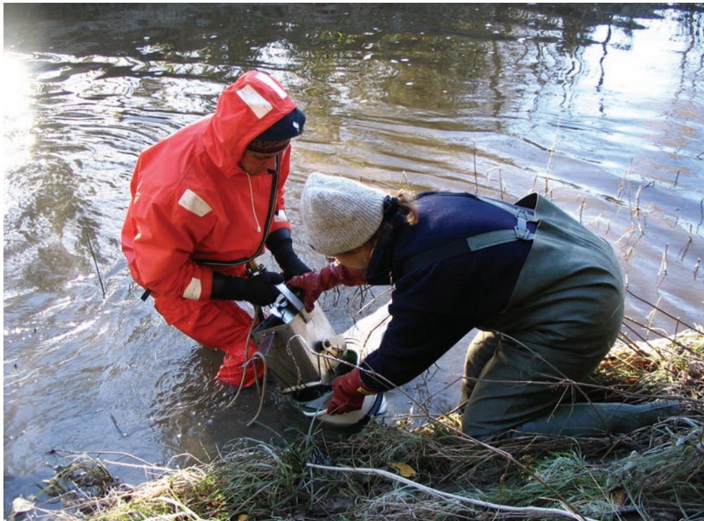
Yleensä pohjanoudinnäytteet haettiin veneellä, mutta joillakin paikoilla näytteenotto onnistui myös kahlaamalla. Kuvassa Ekman-pohjanoutimen tyhjennystä.
