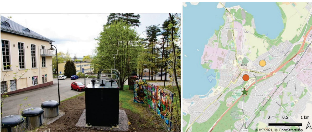
Kuva 9 a-b. Ilmanlaadun mittauspisteet Lohjalla vuonna 2021. a) kartta ja b) valokuva. Jatkuvatoinen asema on merkitty oranssilla ympyrällä, PAH- ja LDSA-mittalaite keltaisella ympyrällä ja typpiidioksidin passiivikeräin vihreällä tähdellä. Bild 9 a-b. Mätpunkterna för luftkvalitet i Lojo år 2021. a) karta och b) fotografi. Mätstationen i kontinuerlig drift är markerad med en orange cirkel, mätpunkten av PAH-föreningar och LDSA med en gul cirkel och passivinsamlaren för kvävedioxid med en grön stjärna.
